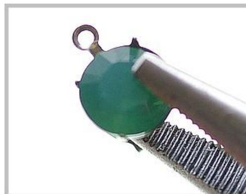
Insérer le strass 8mm dans le support BO et fermer les griffes à l'aide d'une pince plate.
