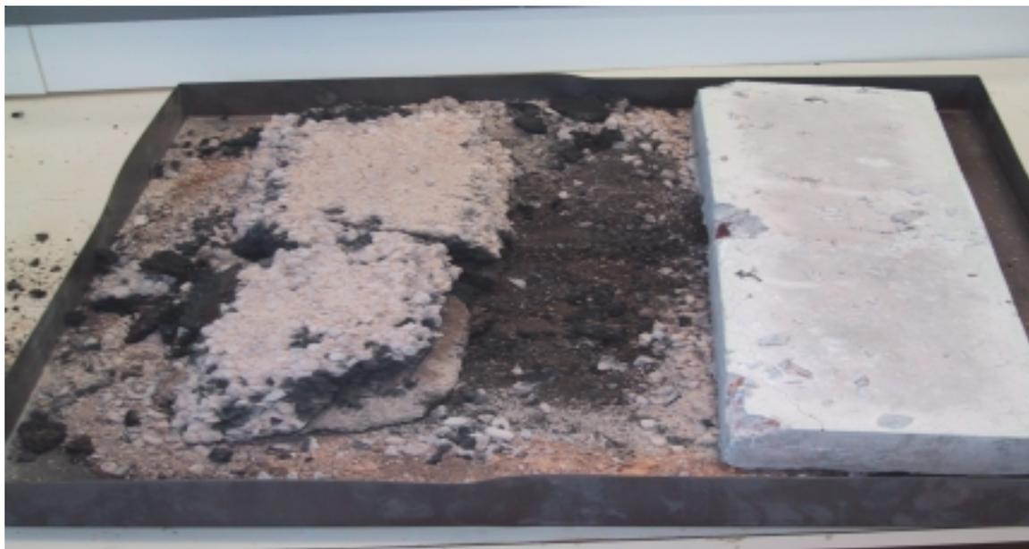
Figure 1 Comparaison d'échantillons d'enrobé hydrocarboné (à gauche) et de béton (à droite) après exposition à une température de 750°C
