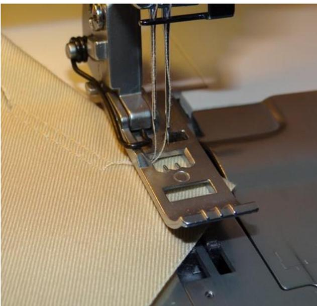
Tirer doucement le tissu vers l'arrière. Couper tous les fils. Passer les fils d'aiguilles sur l'envers et nouer les avec le fil du boucleur.
