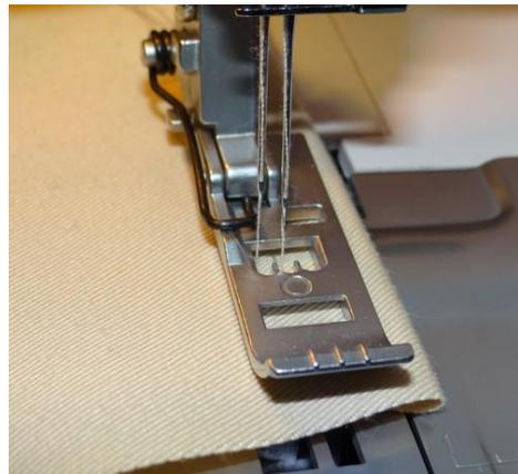
Tourner ensuite le volant une fois dans le sens contraire (sens horaire) jusqu'à ce que les aiguilles soient en position haute. C'est normal de repiquer le tissu (cf
