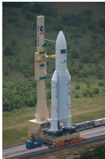
Ci-dessus : transport sur barge d'un élément de fusée. A droite, transfert sur rail de l'ensemble fusée – tour de lancement. A l'extrême droite, la fusée Ariane 5 sur le pas de tir, prête au lancement. Noter la présence des pylônes paratonnerres (il y en a quatre).
